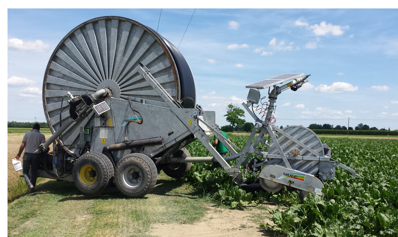
Macchina irrigatrice semovente equipaggiata con dispositivo per l'interposizione di un elemento lineare a basso coefficiente di attrito tra il tubo e la superficie del terreno.
