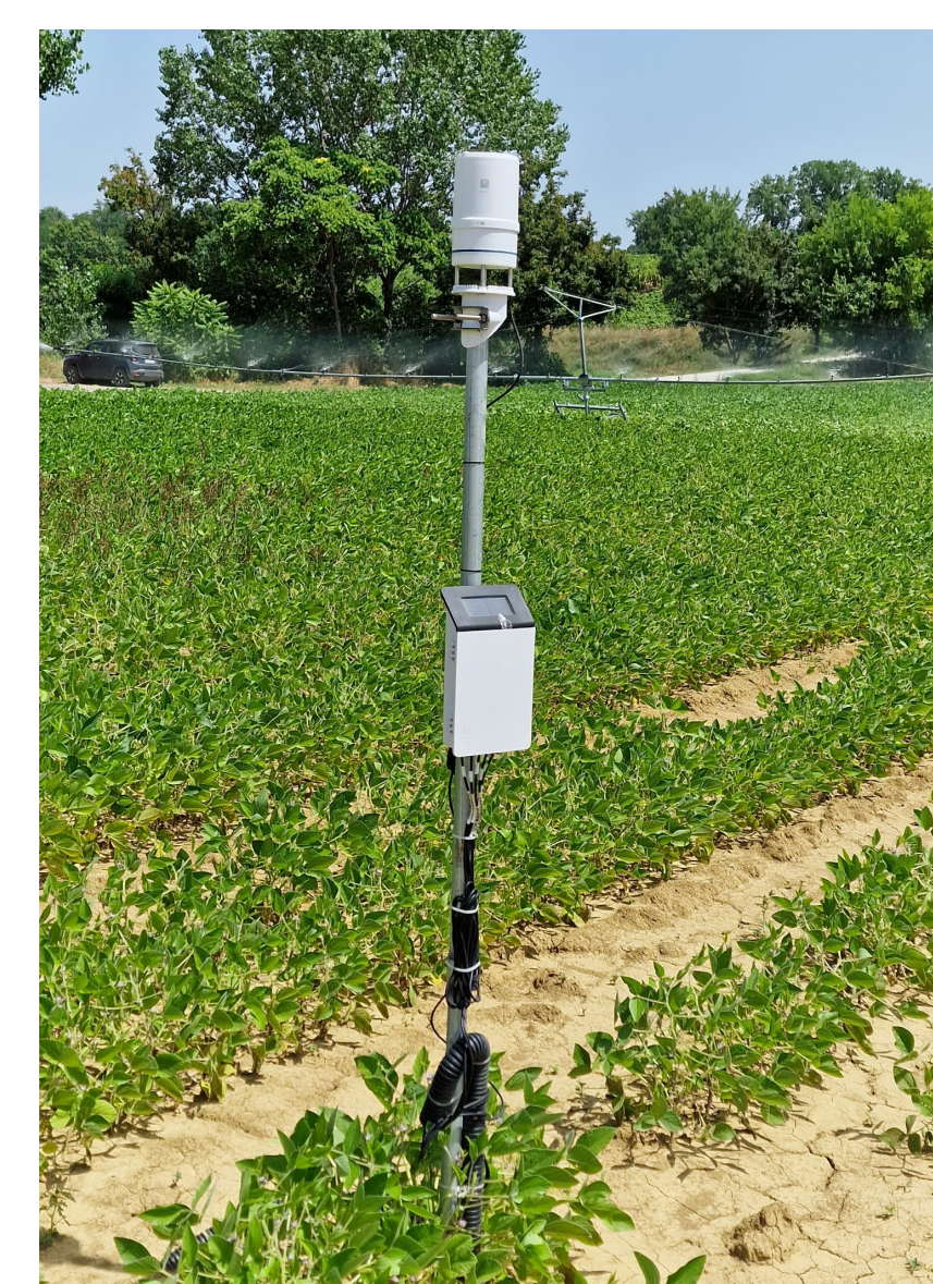
Centralina per l'acquisizione dei dati agrometeorologici necessari al calcolo dell'evapotraspirazione e per il monitoraggio dell'umidità del terreno a 3 profondità.
